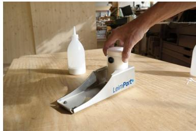
**Schritt 5:** Einsetzen des Klimabehälters in den rutschfesten Edelstahluntersatz.
