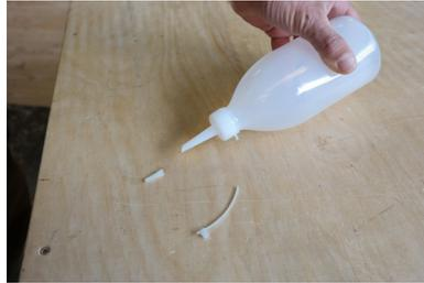
**Schritt 2:** Tülle auf gewünschte Länge kürzen und die Verschlusskappe entfernen.
