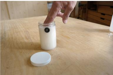
**Schritt 4:** Schaumstoff-Inlay langsam in den Kunststoffbehälter drücken, bis das Wasser vollständig aufgesaugt wurde. Hier auf die Ausrichtung des geschlitzten Schaumstoff-Inlays in Richtung der Membrantülle achten.
