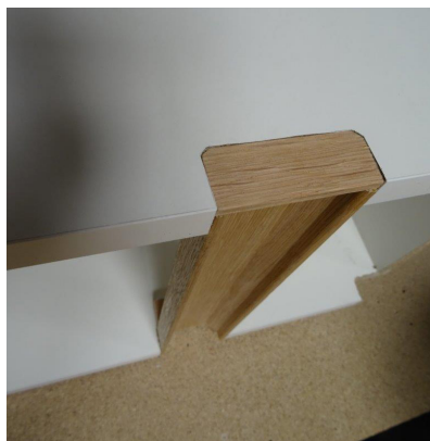
Lipiți capace de capăt- vedere din exterior
