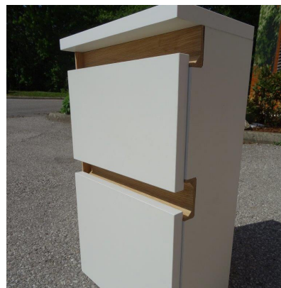
Corp finalizat cu mânere-baghetă din stejar profil L+C și închidere pe o parte
