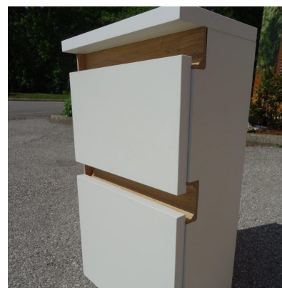
Gotowy korpus z listwami uchwyto- wy z dębu w formie L i C oraz jednos-
