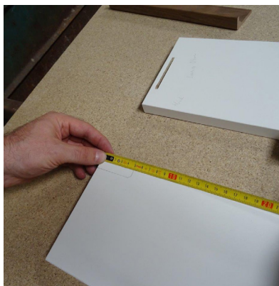
Pomiar dokładnej pozycji listew uchwytowych
