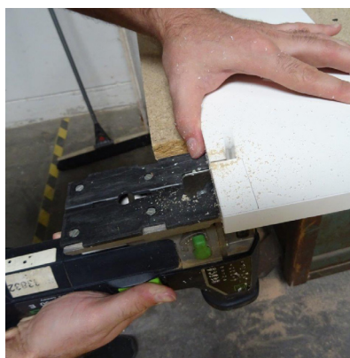
Wycinanie z bocznej części korpusu
