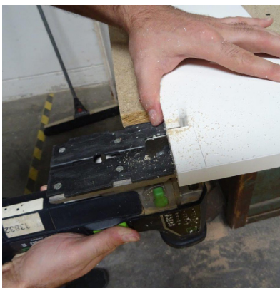
Uitsparingen in de zijpanelen van de kast maken
