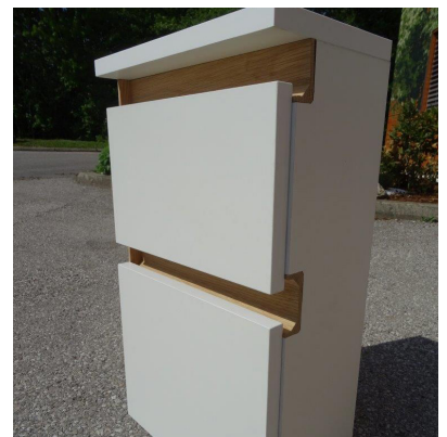
De kast met Eiken komgrepen in L- en C-vorm en aan één zijde eindkappen is gereed
