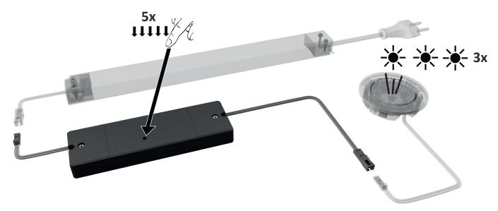
Falls das Gerät bereits unzugänglich montiert wurde, können durch die gleiche Anzahl an unmittelbar aufeinanderfolgende Netztrennungen (Netzstecker ziehen und stecken) die Funktionen ausgeführt werden.
