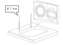
1. Für Beckenausschnitt und Befestigungsbohrungen beiliegende Schablone verwenden. Das Ausschnittsmaß steht auch unter www.alape.com zum Download bereit.
