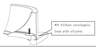
4. Befestigungsscheiben (und Distanzstück) mit Schrauben handfest anziehen und anschließend Becken ausrichten.
