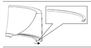
3. Das Kantenprofil umlaufend auf die Einkantung der Beckenunterseite aufziehen. Je nach Beckenmodell muss das Profil abgelängt werden.
