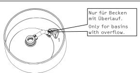
2. Ventil und ggf.Überlauf montieren.
