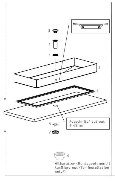
1. Stülpdichtung (1) des Schaftventils im Ablaufloch des Beckens (2) einsetzen.
