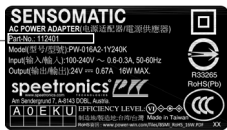
Fig. 2: Numéro d'article Alimentation pour une unité d'éjection
